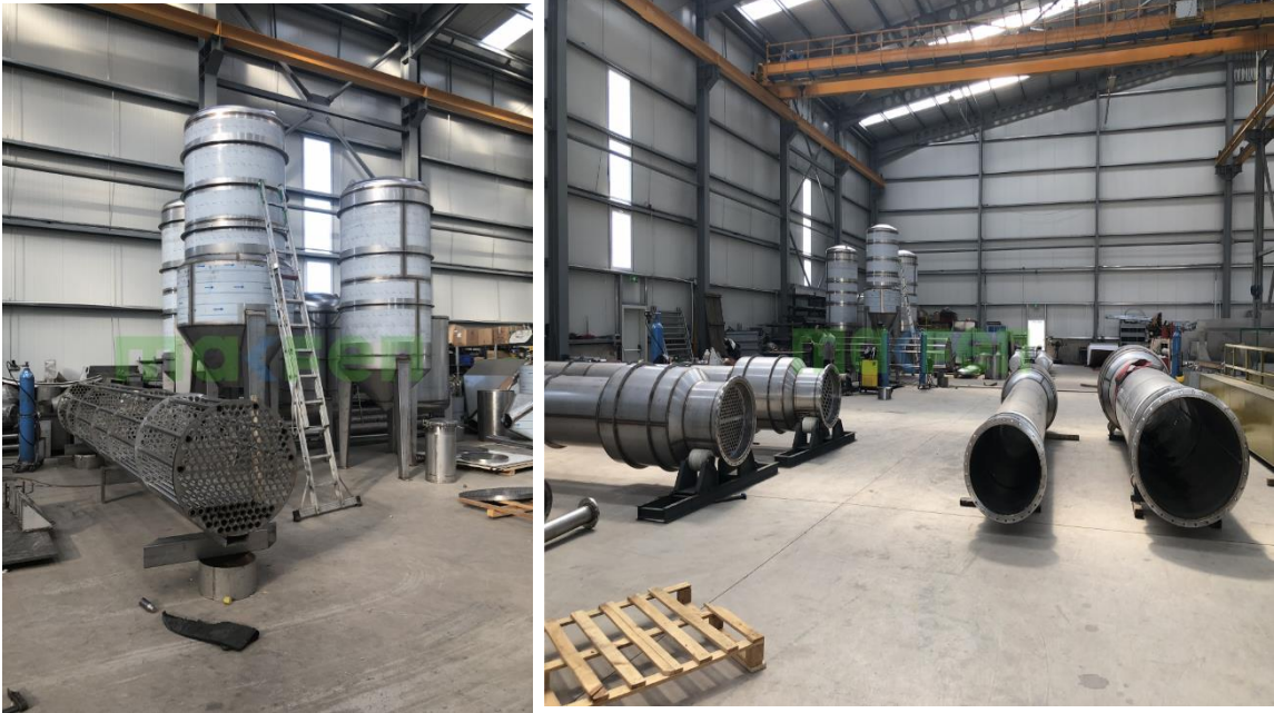
Şekil 13. İnce Film Isı Değiştirici-Evaporatör Uygulaması [109]
