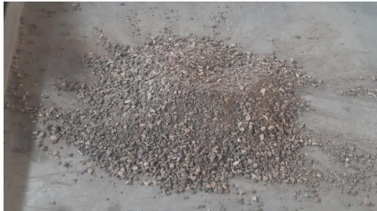
Şekil 3.5. Kazınmış asfalt atığının görünümü
