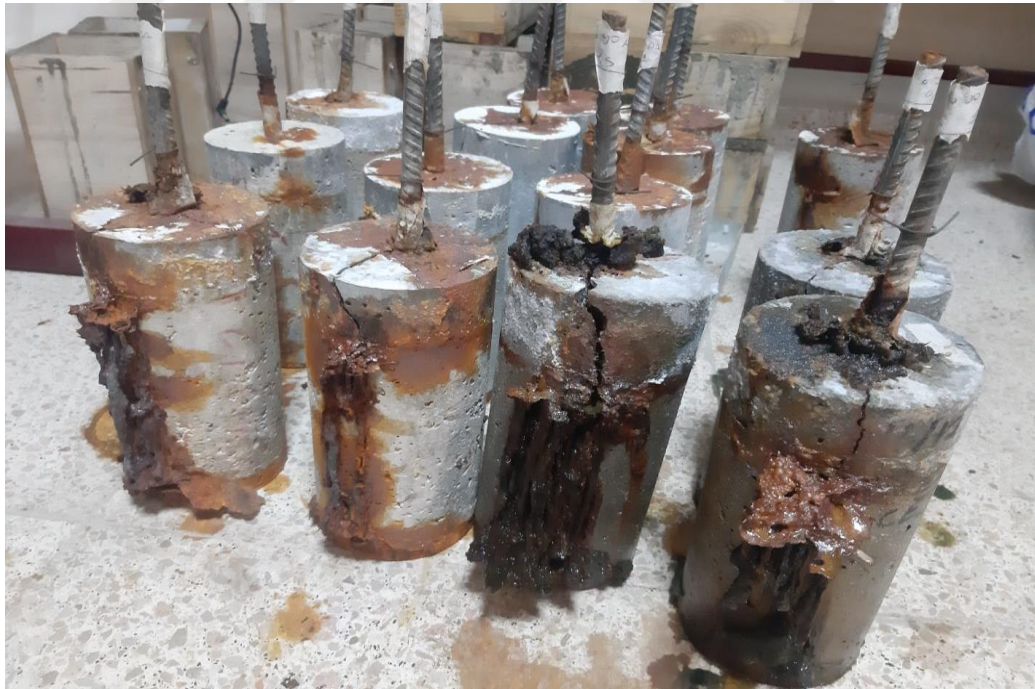
Şekil 3.23. Korozyona uğrayan beton numuneleri
