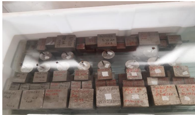
Şekil 3.12. Kür havuzundaki numunelerin görünümü
