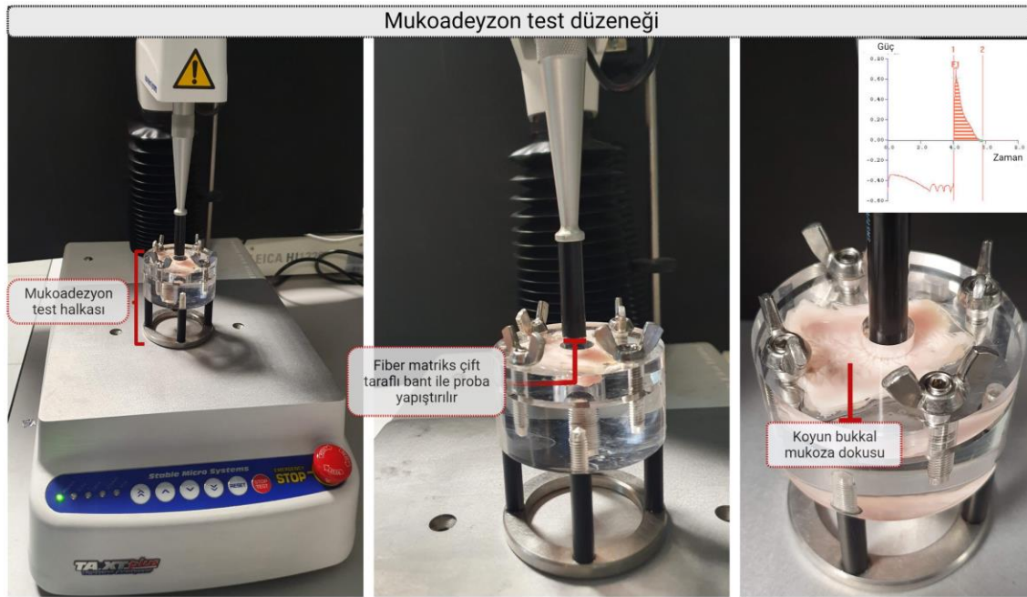
Şekil 3.2. Tekstür analiz cihazı ile yapılan mukoadezyon test düzeneği.
