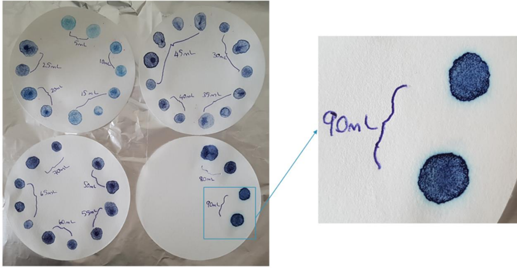
Şekil 3.1. ANSI/ASTM C837-76 standardına göre yapılan metilen mavisi deneyi.
