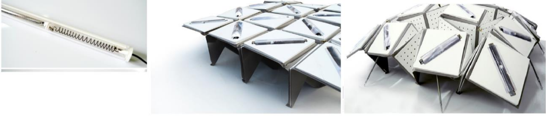
Şekil 59. Elektrik aktivasyonlu ŞHA Nitinol ve çinkonun beraber kullanımı ile gerçekleştirilen prototip ( www.designboom.com ).
