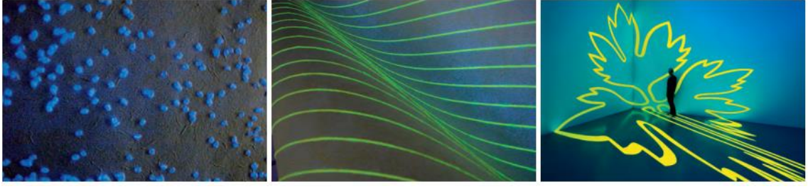
Şekil 41. Mavi floresan granüllü kağıt, kağıt üzerine yeşil floresan iplik uygulaması ve floresan film kaplamalı duvar (Ritter,2007)
