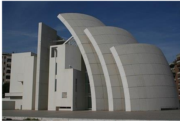
Şekil 38. Cephesinde TiO_2 pigment katkılı fotokatalitik çimento malzeme kullanılan Jübile Kilisesi ( stringfixer.com -b)
