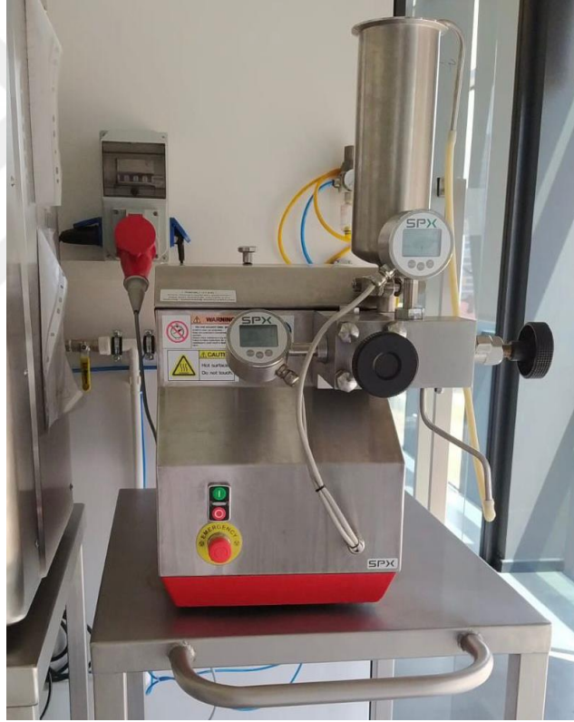
Şekil 3.2 Emülsiyon eldesinde kullanılan homojenizatör cihazı
