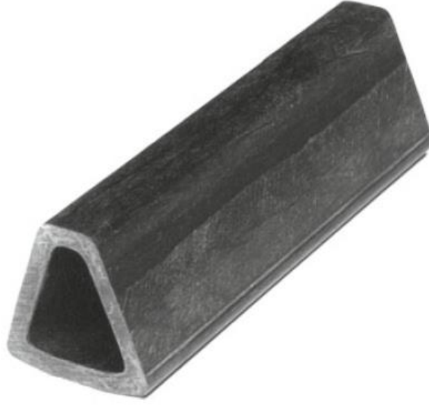
Şekil 3. 5 Pultrüzyon üretim yöntemi ile elde edilmiş polimer matrisli kompozit
