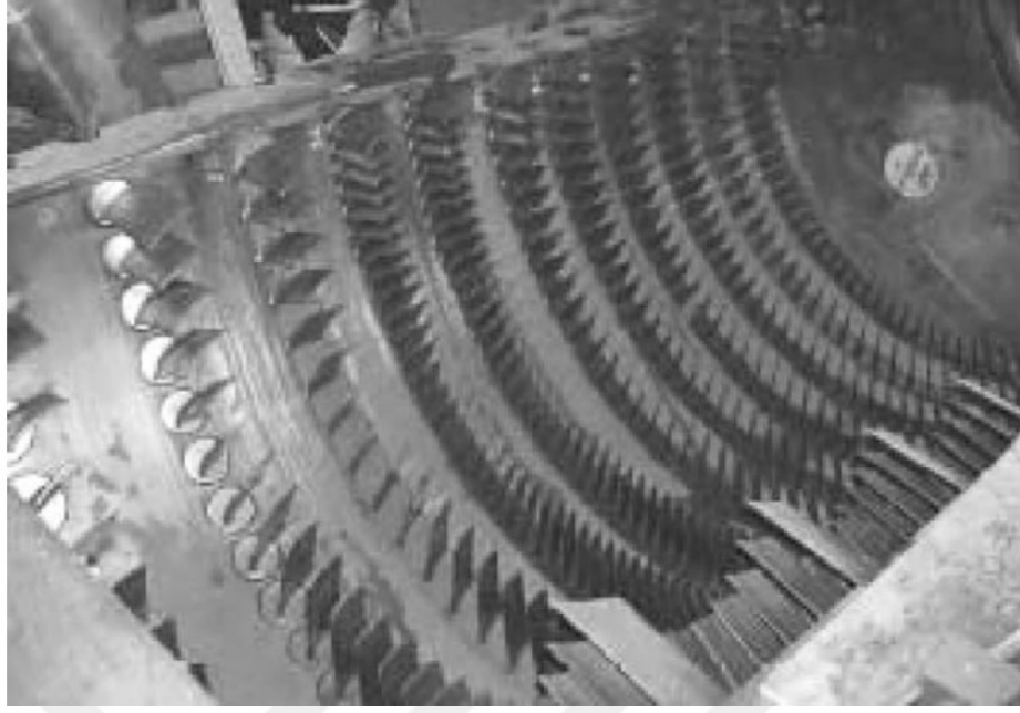
Şekil 2.4 Eksenel Akımlı Kompresörün Gövdede Bulunan Statorlar [17].
