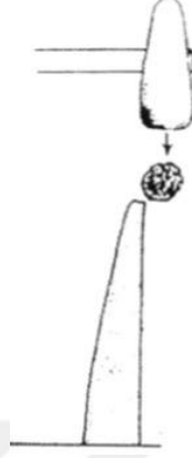
Resim 2.12 : Sabitlenmiş metal bir çubuk üzerinde taşın çekiç yardımıyla yontulmasını gösteren çizim.
