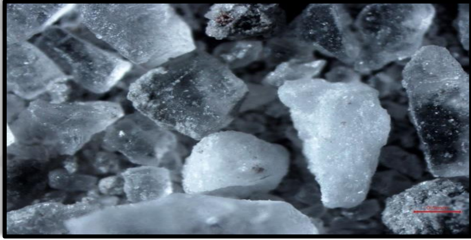
Şekil 4.26 KT_1 'in 50µmlık kesitleri (E536 katkılı tuz)
