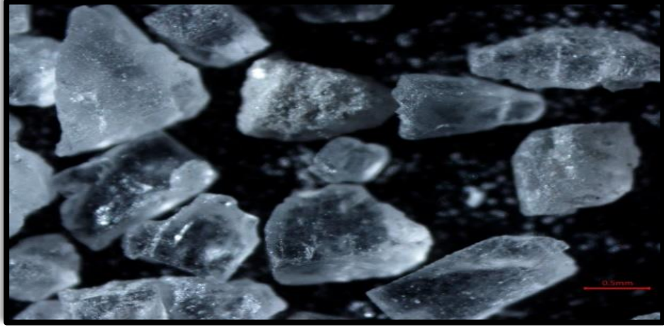
Şekil 4.19 D 3 'ün 50µm lik kesitleri dekantör aşaması (2. yıkama)
