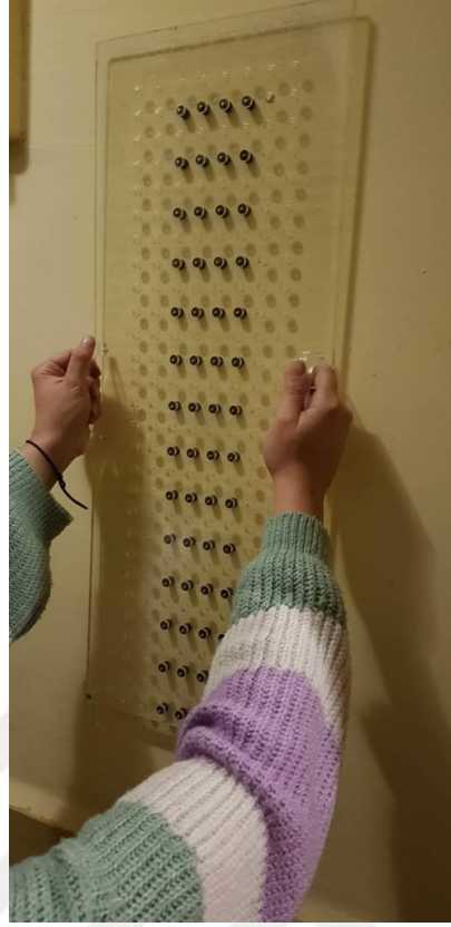
Şekil 5.5 Geliştirilen ölçüm düzeneğinin ölçüm yapı taşıyıcı sistem elemanı ile konumu. Görselde tek pleksiglas levha kullanılmış ve x-yönünde 2.5 cm aralıklı 4 elektrot, y-yönünde 5 cm aralıklı 14 elektrotlu durum görülmektedir (toplam 56 elektrot)
