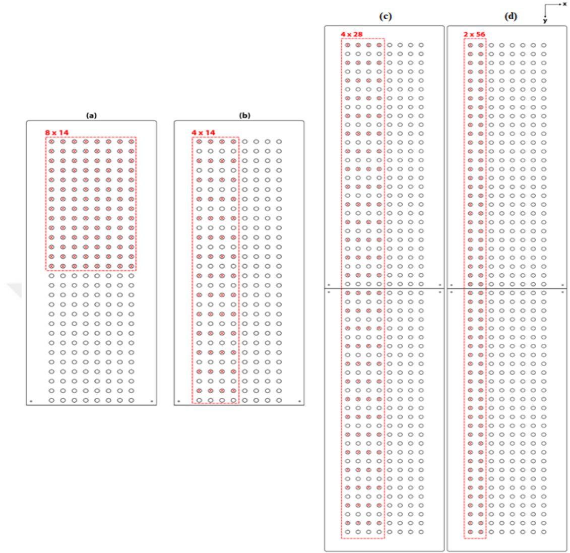
Şekil 5.4 Tek pleksiglas levha kullanımı için iki örnek: (a) x-yönünde 2.5 cm aralıklı 8, y-yönünde 2.5 cm aralıklı 14 elektrot (b) x-yönünde 2.5 cm aralıklı 4, y-yönünde 5 cm aralıklı 14 elektrot, iki pleksiglas levha kullanımı için iki örnek: (c) x-yönünde 2.5 cm aralıklı 4, y-yönünde 5 cm aralıklı 28 elektrot (d) x-yönünde 2.5 cm aralıklı 2, y-yönünde 2.5 cm aralıklı 56 elektrot (kırmızı x işaretleri aktif elektrotları göstermektedir)
