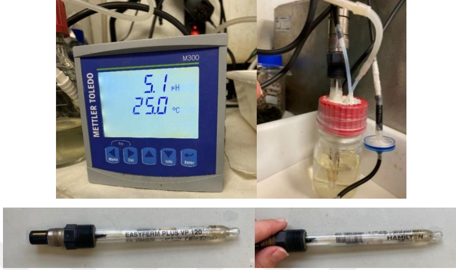
Şekil 3. 50. pH kontrolörü (Mettler-Toledo AG- Undorf, İsviçre) ve prob (Hamilton)
