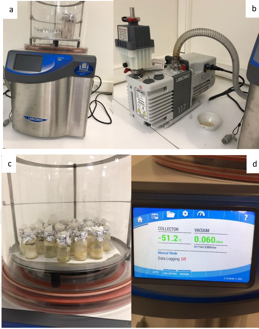
Şekil 3.23. Liyofilizasyon işlemi a) Liyofilizatör, b) Liyofilizatör vakum pompası, c) Liyofilizatör numune haznesi, d) Liyofilizatör ekranı
