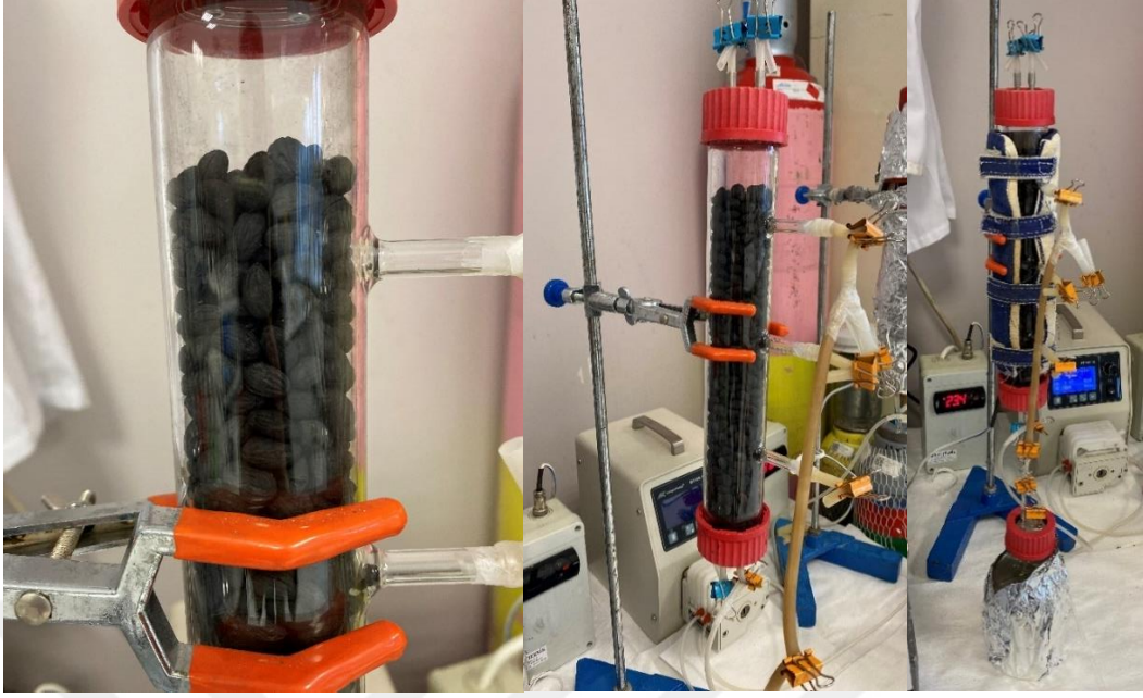
Şekil 3. 41. Biyokömürün immobilize materyal olarak kullanıldığı kesikli beslemeli immobilize biyoreaktör düzeneği
