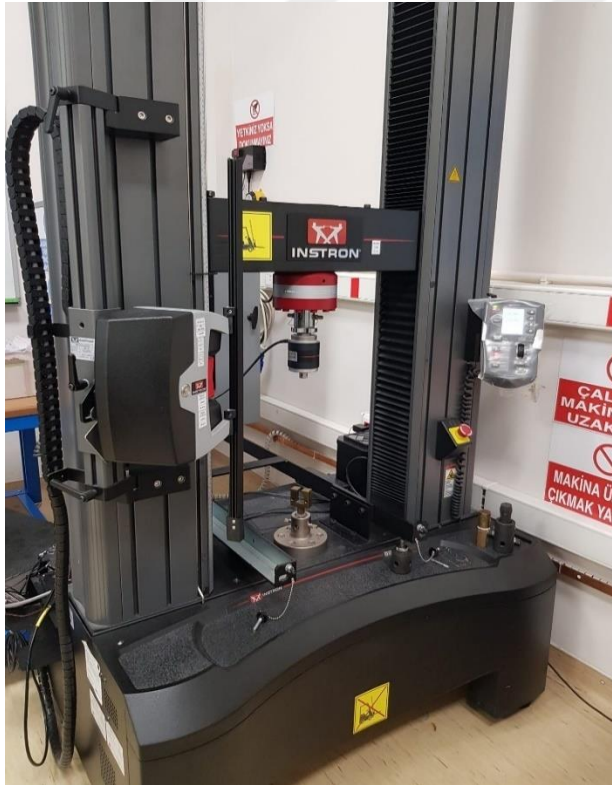
Şekil 4.20. Çekme testinin yapıldığı çekme testi cihazı
