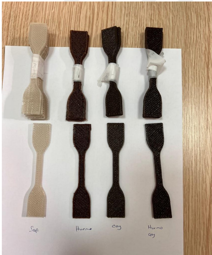
Şekil 4.17. 3D baskı ile üretilen çekme testi numuneleri
