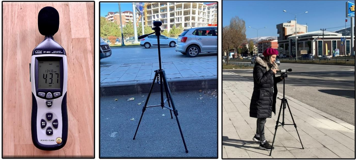
Şekil 22. Yerden 1,5 m yükseklikten gürültü ölçümleri Sonometre cihazı ile yapılmıştır.
