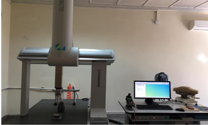
Şekil 4.4. Hexagon Global Performance CMM cihazı
