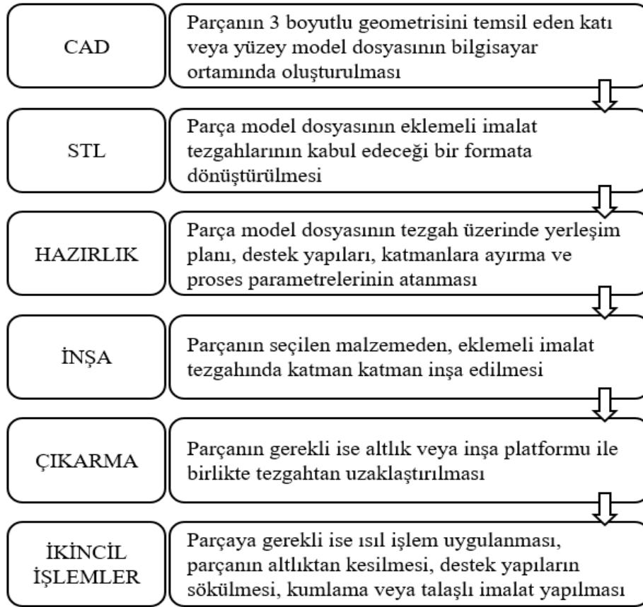
Şekil 3.1. Eklemeli imalatta temel aşamalar [6]
