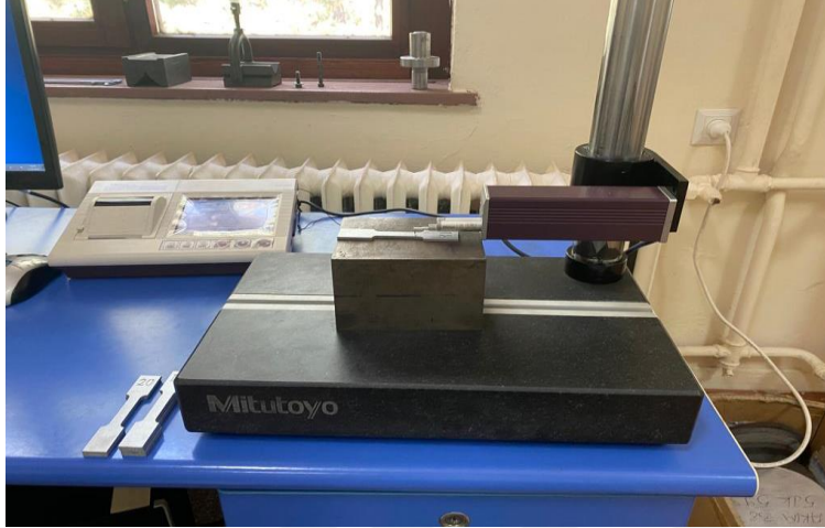
Şekil 4.5. Mitutoyo SJ-410 profilometre
