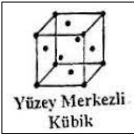
Şekil 2.4. Yüzey Merkezli Kübik Yapı
