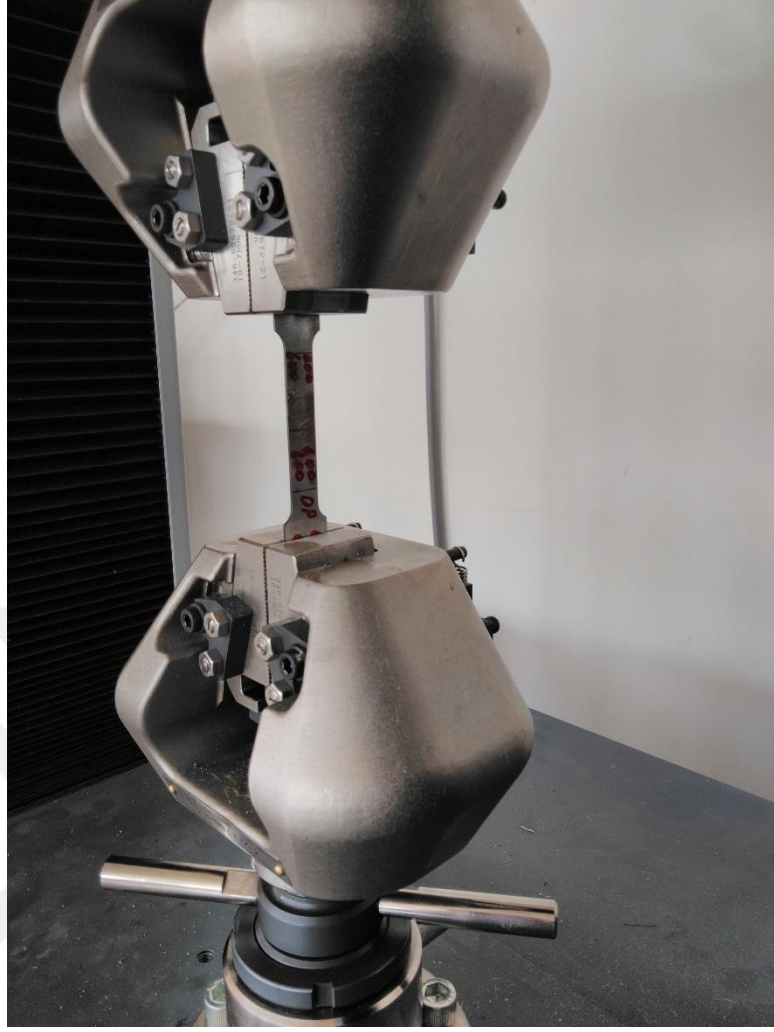
Şekil 3.16. Çekme testi cihazına numunenin bağlanması
