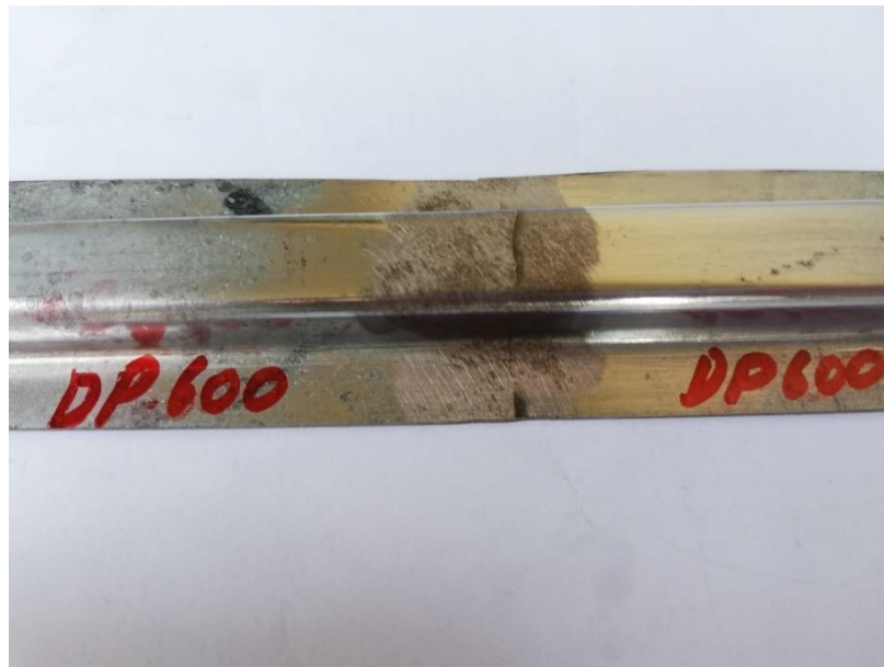
Şekil 4.33. Kaynaklı DP600-DP600 deney numunesinin bükülmüş görünümü
