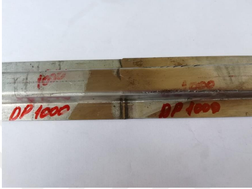
Şekil 4.34. Kaynaklı DP1000-DP1000 deney numunesinin bükülmüş görünümü
