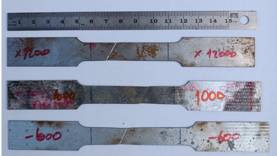
Şekil 4.20. Kaynaksız numunelerin çekme testi sonrası
