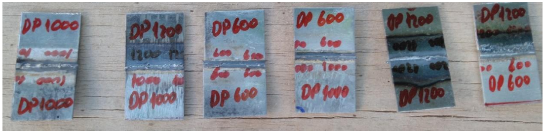
Şekil 3.8. Kaynak birleşimi yapılan numune kesitleri
