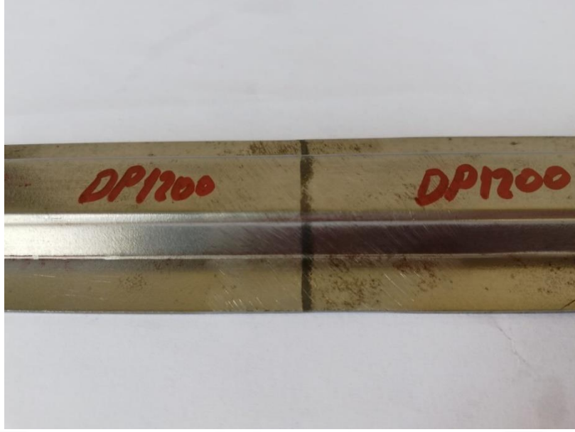
Şekil 4.29. Kaynaklı DP1200-DP1200 deney numunesinin bükülmüş görünümü
