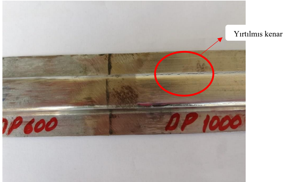
Şekil 4.30. Kaynaklı DP600-DP1000 deney numunesinin bükülmüş görünümü
