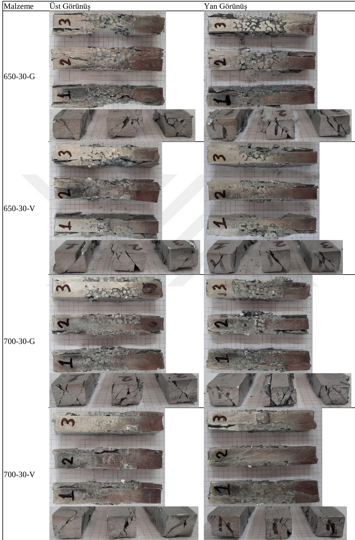
Resim 7.22. 30 ppi takviyeli FDM numunelerin basma testi sonrası görüntüleri
