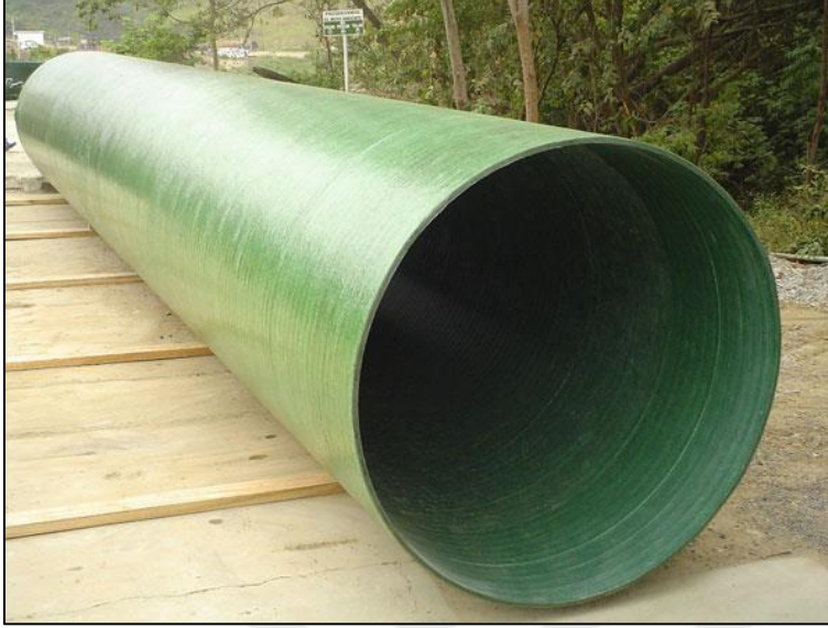
Resim 2.3. Su iletimi için üretilmiş bir filament sargılı boru [22]
