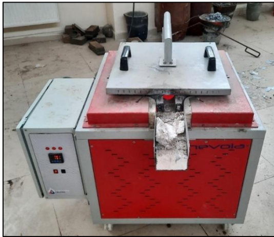
Resim 6.5. Elektrik dirençli ergitme fırını
