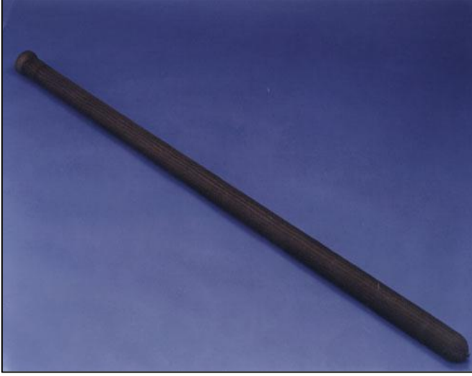
Resim 2.2. SiC matrisli Nextel 312 seramik fiber takviyeli mum tipi bir filtre [22]
