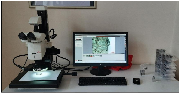
Resim 6.14. Stereo mikroskopta kırık yüzey incelemesi
