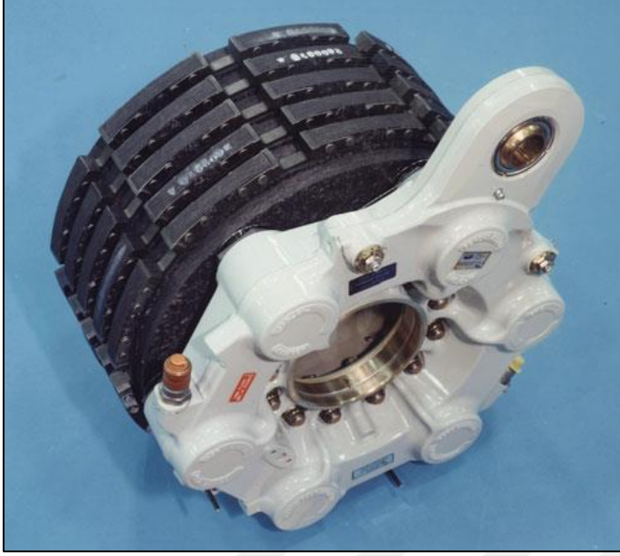
Resim 2.4. Boeing 767 uçağına ait bir karbon/karbon fren düzeneği [22]
