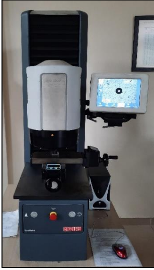
Resim 6.12. Sertlik ölçüm işleminin uygulanması
