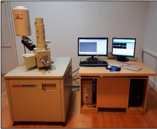
Resim 6.11. Detaylı yapısal inceleme ve EDS analizlerinin yapılması
