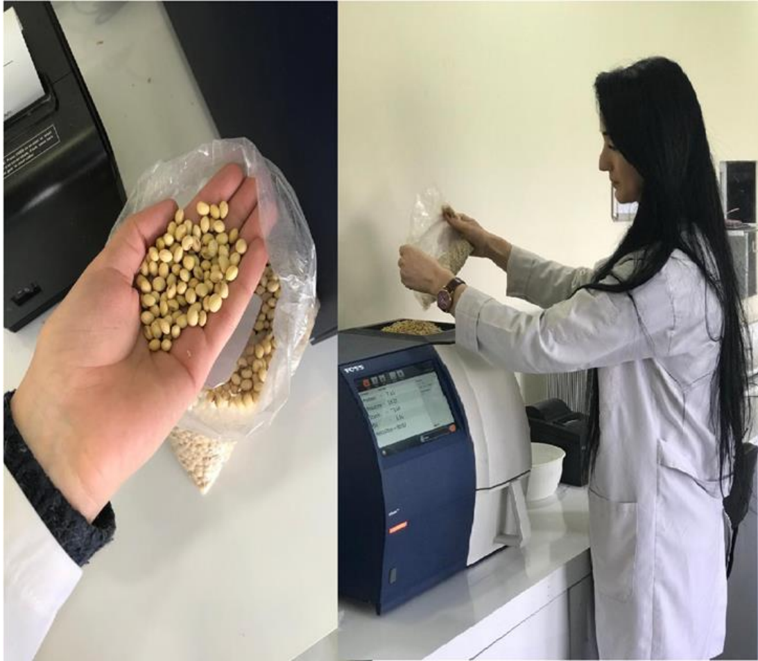
Şekil 3.14 Soya tanesinde kalite analizlerinin NIT cihazında ölçümü
