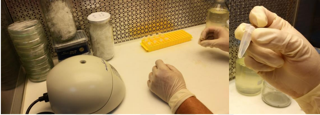
Şekil 3.5.Solda: Minispin’de santrifüj işlemi, Sağda: 1,5’luk eppendorf tüpünde enzim protoplast karışımının görüntüsü
