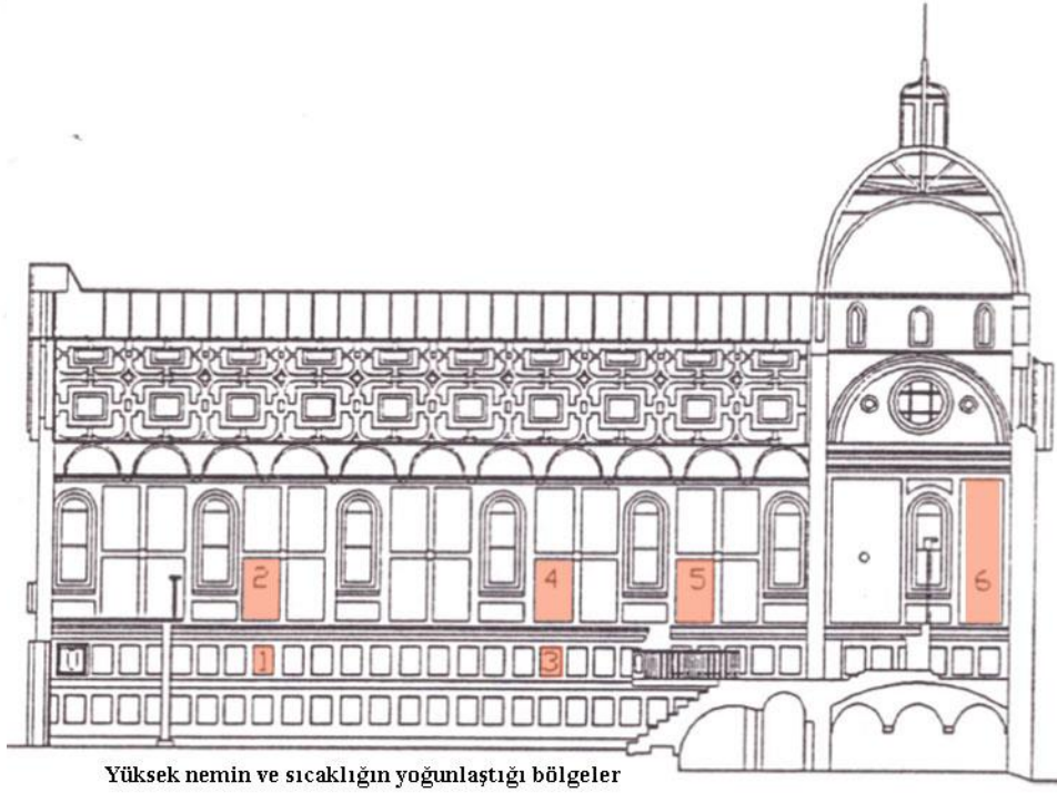
Şekil 6.59 Mirocoli Kilisesi Kanal Cephesi Yüksek Nem ve Sıcaklığın Yoğunlaştığı Kısımlar [128]
