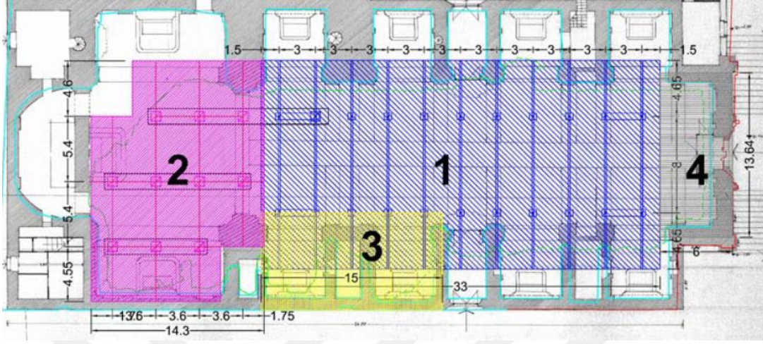
Şekil 6.72 Santa Maria Kilisesi'nde Kullanılan FRP Sistemi [145].
