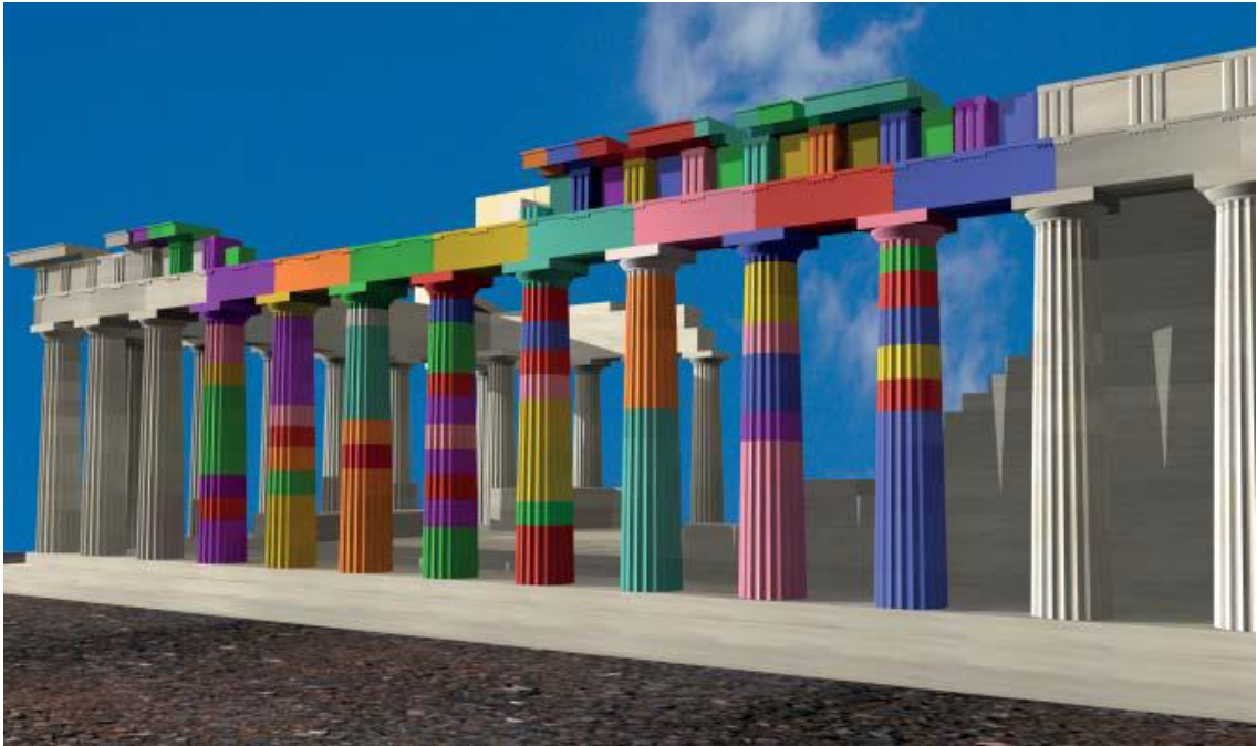
Şekil 6.12 Parthenon'nun Kuzey Cephesindeki Balanos Restorasyonunda Elemanın Yanlış Yerleştirilmesi (her sütun, bitişik saçaklığına uygun bir renk olmalıdır) [89]
