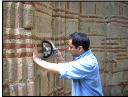
Şekil 4.6 P Tipi Schmidt Çekici Testi Uygulaması [30]
