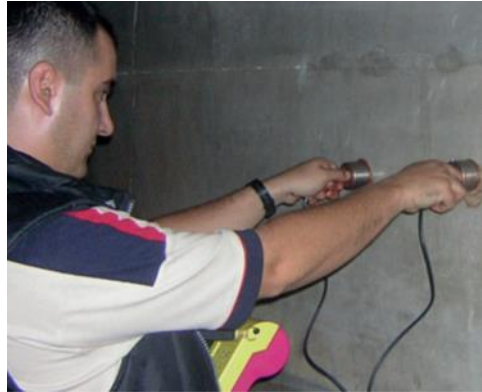
Şekil 4.4 Ultra Ses Deneyi [7]
