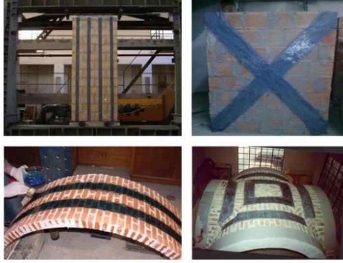
Şekil 5.11 FRP şerit yöntemi [63].
