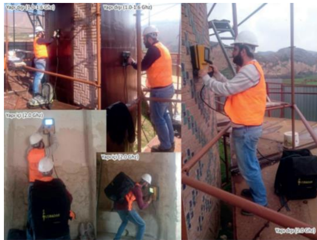
Şekil 4.8 Yapı İçinde ve Dışında Georadar Uygulaması [8]
