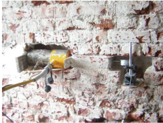
Şekil 4.10 Yerinde Kayma Deneyi [40]
