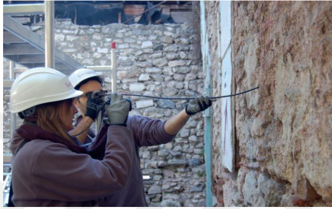
Şekil 4.11 Tarihi Yapılarda Endoskopi Yöntemi [7]
