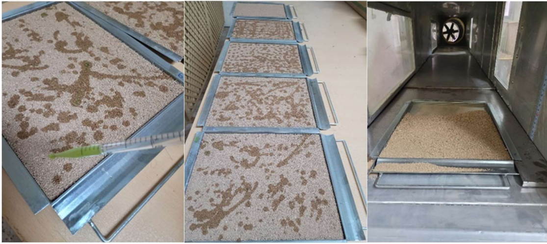
Şekil 3.18 Uygulama sonrası rüzgar erozyonu sonucu ortaya çıkan toprak kaybının belirlenmesi
