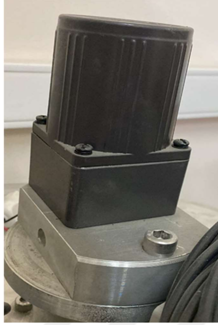
Şekil 3.2 Biyoreaktörde karıştırma işlemi için kullanılan motor
