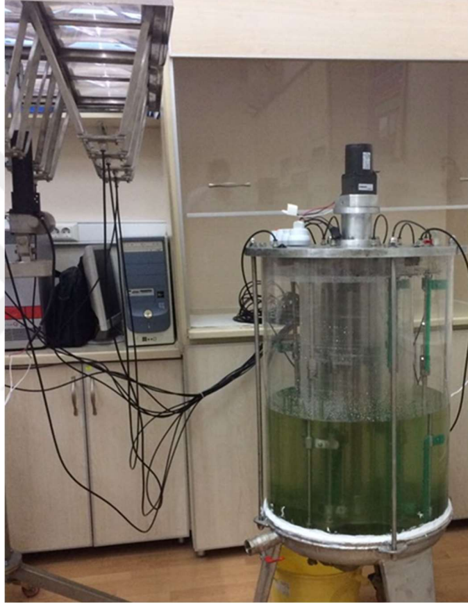
Şekil 3.13 Laboratuvar ölçekli solar biyoreaktöre aktarılan mikroalgler
