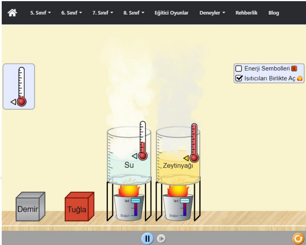
Şekil 28. Online deney örneği (Kaynama noktasının ayırt edici özellik olduğunu ispatlamaya yönelik bir online deney)
