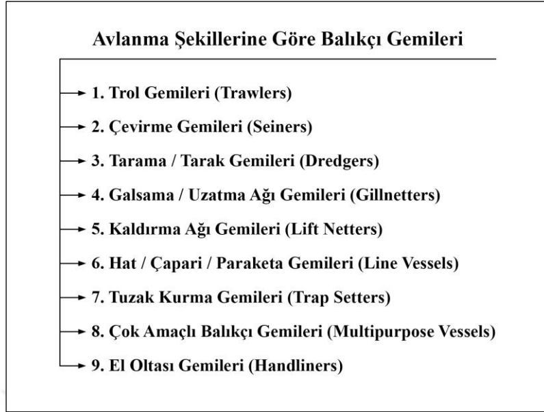
Şekil 1.1. Avlanma şekillerine göre balıkçı gemilerinin sınıflandırılması (FAO, 1985; MEGEP, 2008).
