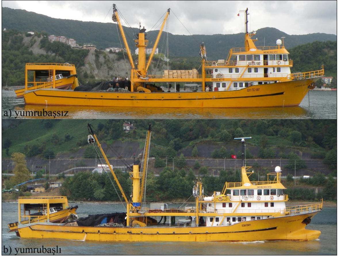
Şekil 2.33. Bir Karadeniz tipi balıkçı gemisinin yumrubaşsız (a) ve yumrubaşlı (b) hali (URL-2, 2022).
