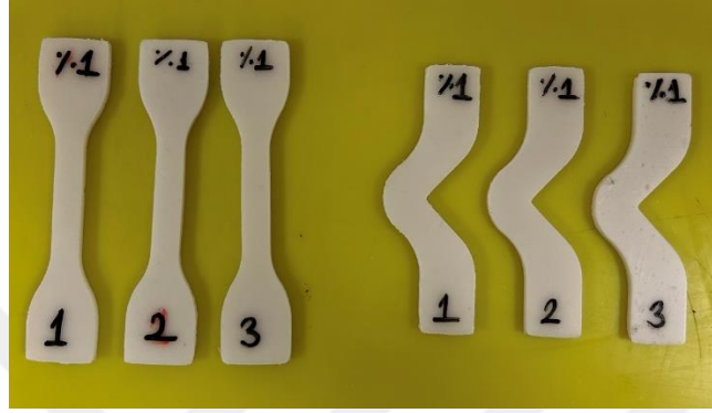
Şekil 3.5. Standartlara uygun kesilen, solda kopma numuneleri, sağda yırtılma testi numuneleri
