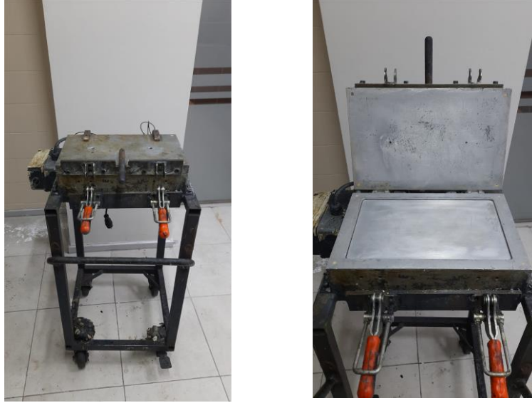
Şekil 3.3. Plaka dökümlerinde kullanılan ısıtmalı kalıp.
