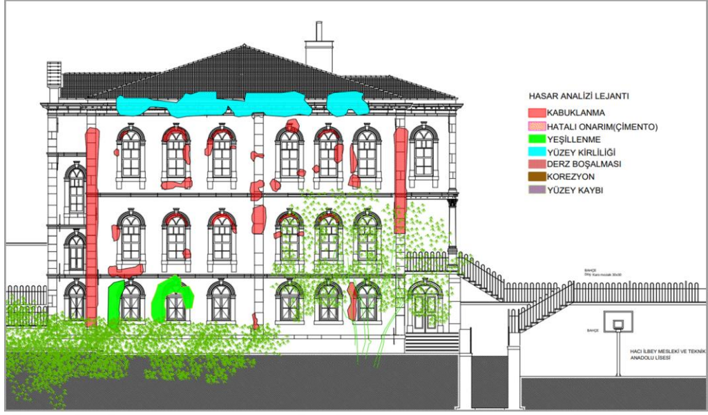
Şekil 5.14: Güneydoğu Cephesi Hasar Analizi
