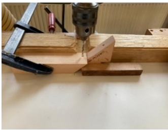
Şekil 3.18. Köşe takozuna vida kılavuz deliği açmada kullanılan kalıp düzeni
