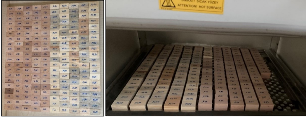
Resim 3.1. Rutubet tayini için hazırlanan numuneler ve kurutma aşamasındaki serim düzeni
