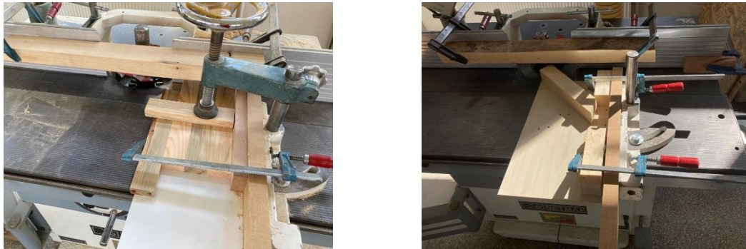
Şekil 3.15. Frezede parça işlemede kullanılmak üzere hazırlanan kalıp görüntüleri
