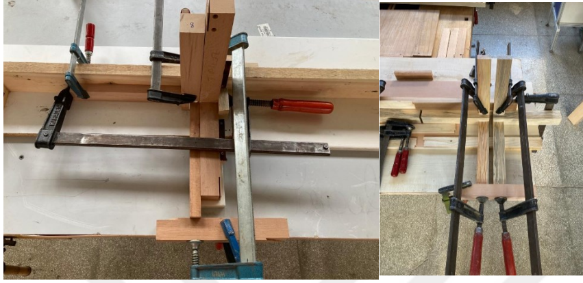
Şekil 3.19. Tutkallama kalıp düzeni
