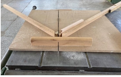
Şekil 3.16. Gönye burun kapak düşürme ve birleşim açısı düzeltmede kullanılan kalıp düzeni
