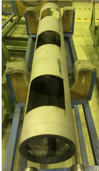
Şekil 4.10: Çekme Test Kuponlarının Çıkarıldığı Yerler
