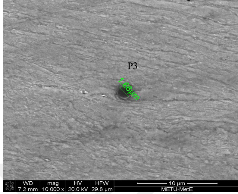
Şekil 4.34: Sıvama + Yaşlandırma Sonrası Tane İçinde 2. Faza (P3) ait görüntü ve boyutu x10000.
