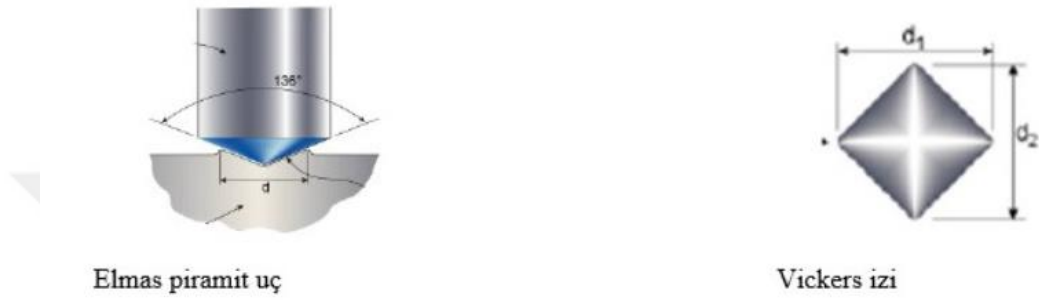
Şekil 3.13: Elmaz Piramit Uç ve Vickers İzi
