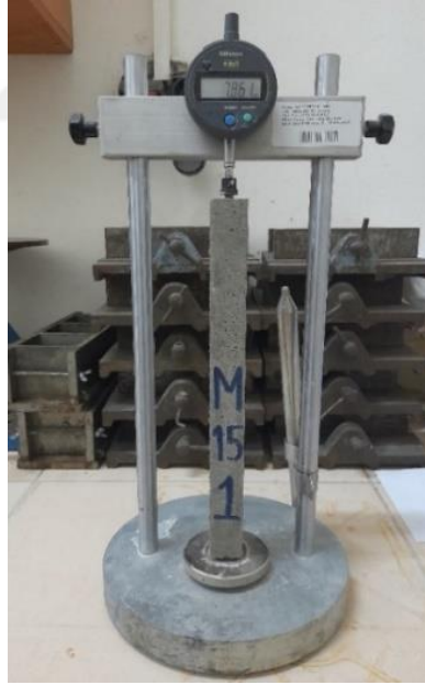
Şekil 20. Prizmatik numunelerin boy ölçme aparatı
