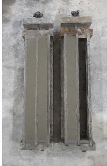
Şekil 18. Prizmatik metal kalıplarda harç çubuk numuneler
