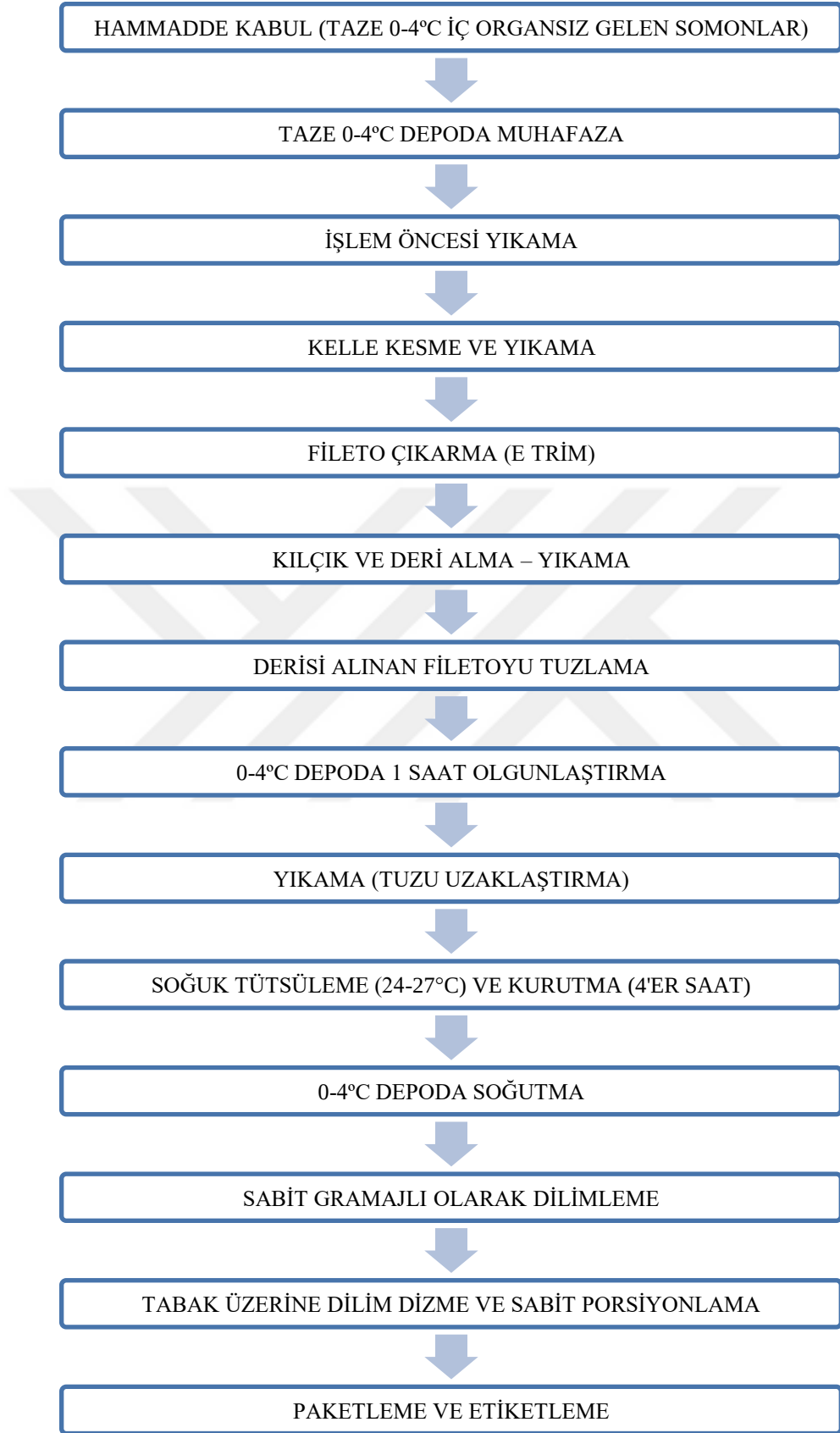
Şekil 3.3. Tütsüleme işlemi akış şeması
