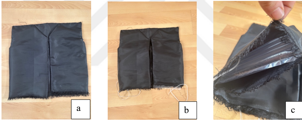
Şekil 4.2 Konsept tasarımın boş (a), hava keseli hali (b) ve hava kesesinin yakından görünüşü
