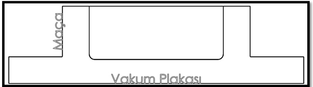
Şekil 3.18: Maça kalınlığı azaltılmış tasarım-Tasarım 3.
