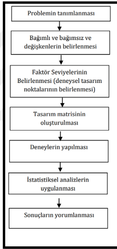
Şekil 4.2: Tam Faktöriyel deney tasarımı akış şeması.
