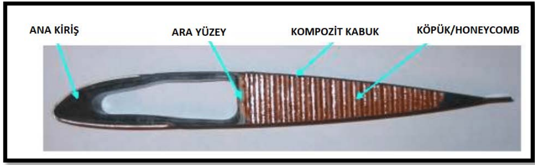
Şekil 5.1: Kompozit rotor palinin kesiti.
