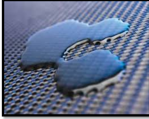
Şekil 2.18: Reçinenin karbon kumaşa emdirilmeden önceki hali.
