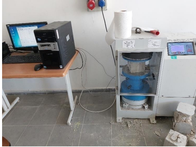
Şekil 3.5. Sıcaklığa bağlı olarak beton numunelerinde oluşan yük kapasitesi ve basınç dayanımının ölçülmesi
