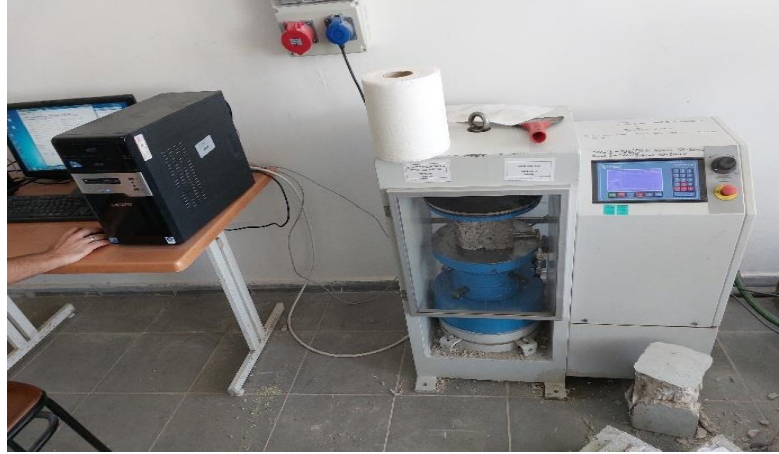
Şekil 3.9. Sıcaklığa bağlı olarak SSB numunelerinde oluşan yük kapasitesi ve basınç dayanımının ölçülmesi
