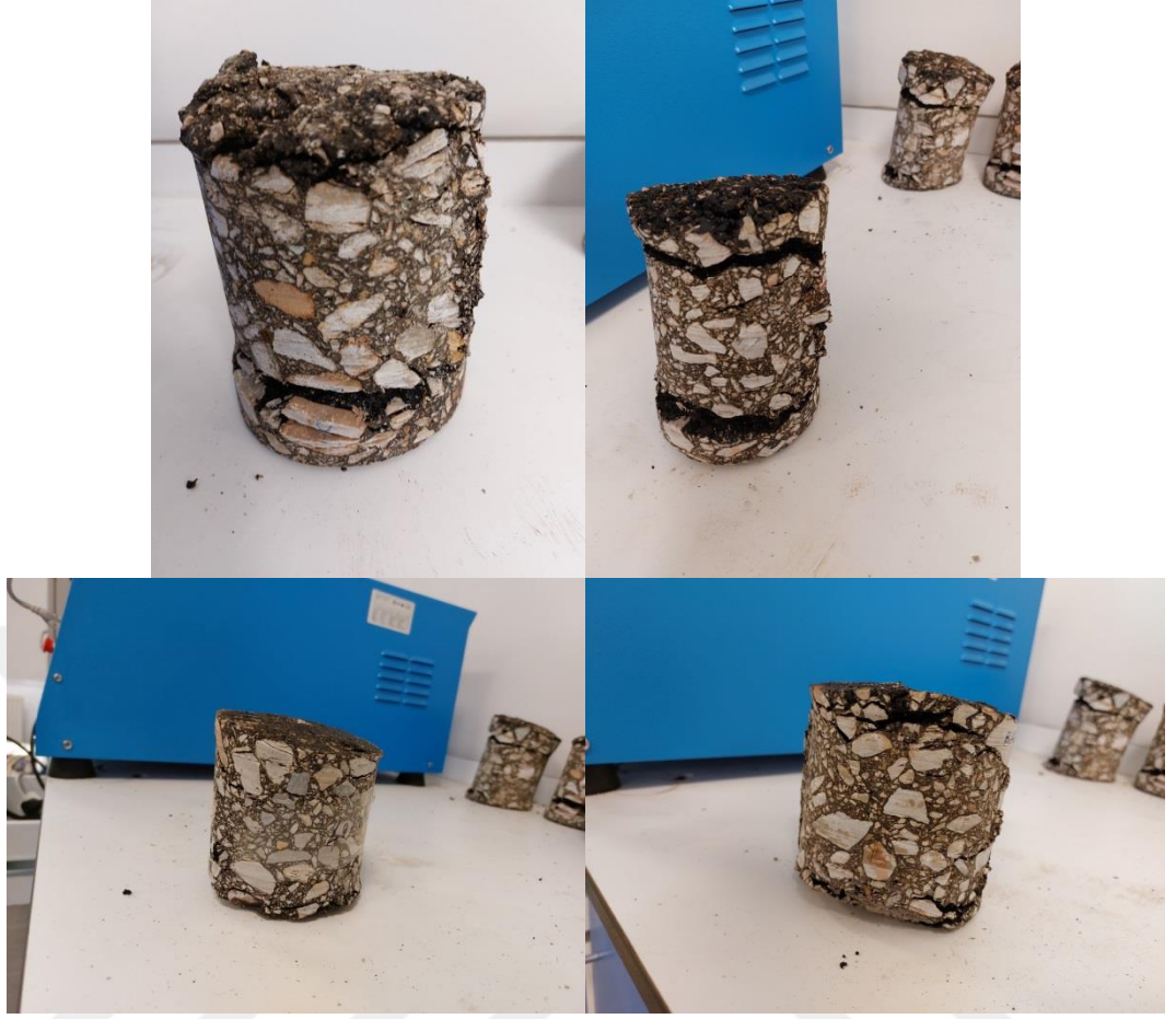
Şekil 3.3. BSK numunelerinde sıcaklığın (20, 30, 40 ve 50 °C) etkisine bağlı olarak deneyler sonrası meydana gelen deformasyonlar
