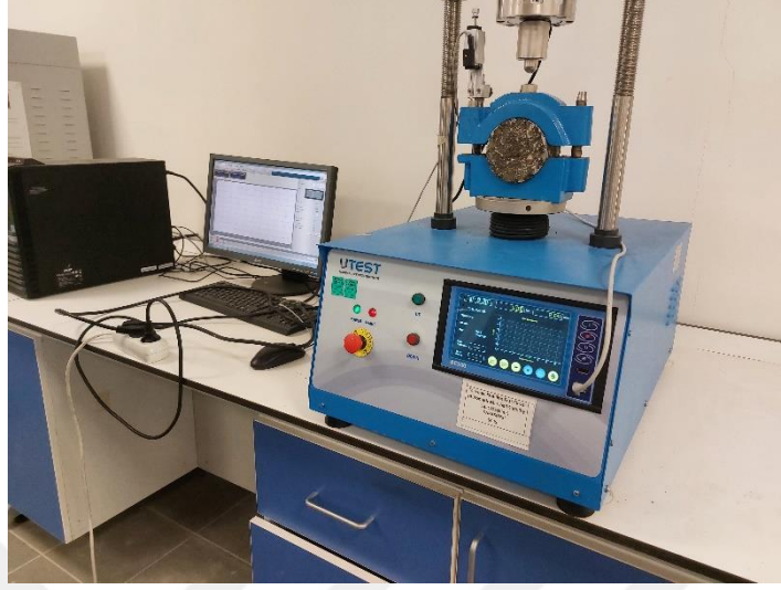
Şekil 3.1. BSK numunelerinde sıcaklığın etkisine bağlı olarak stabilite, yükleme, akma ve gerilme değerlerinde meydana gelen değişikliklerin ölçülmesi
