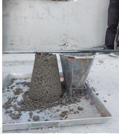
Şekil 2.5. Çökme Deneyi (Slump Testi)
