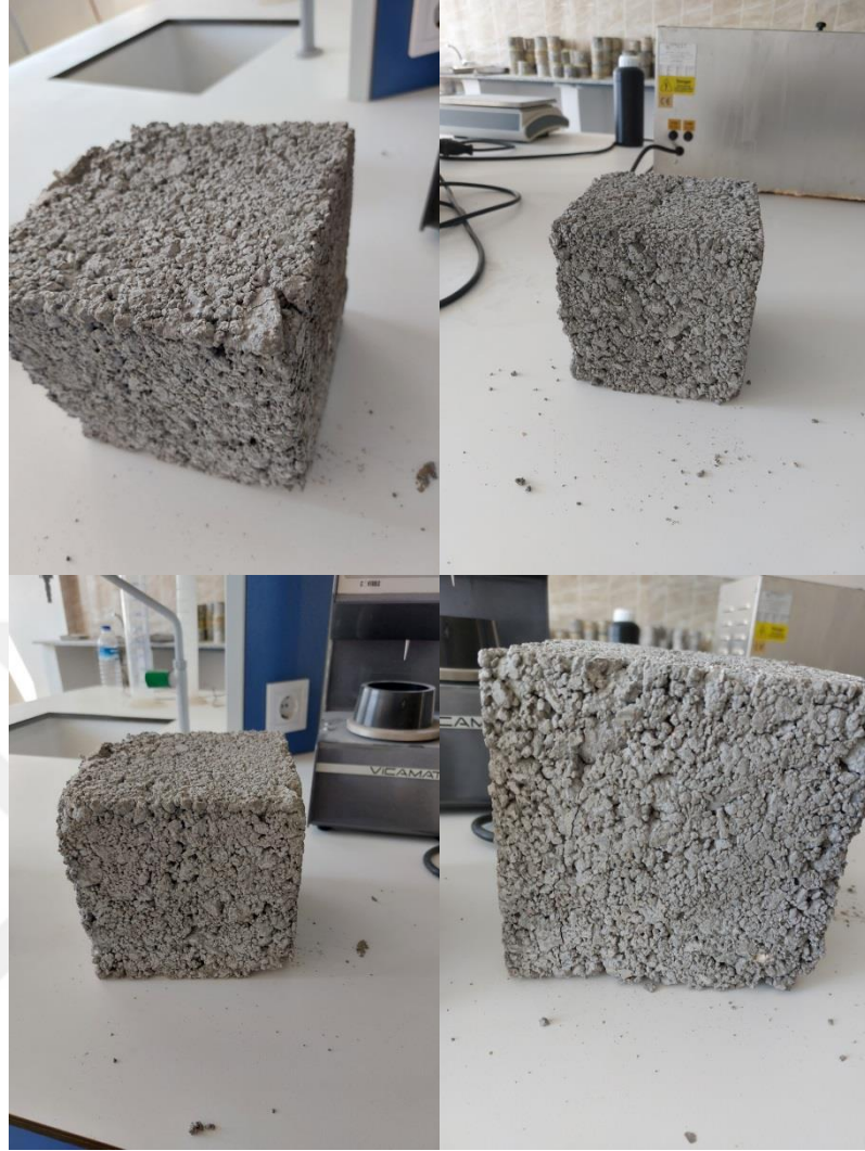
Şekil 3.11. Sıcaklığa bağlı olarak (20, 30, 40, 50 °C) SSB numunelerinde deneyler sonrası meydana gelen deformasyonlar
