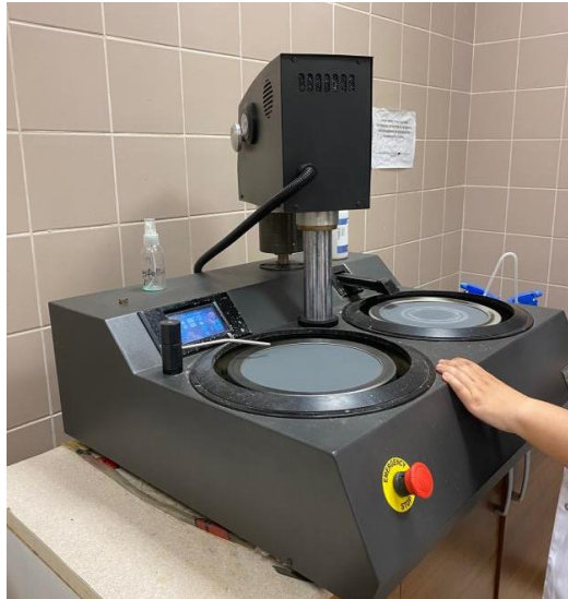
Şekil 4.8. Mikrotest Multipol Advanced otomatik zımparalama ve parlatma cihazı
