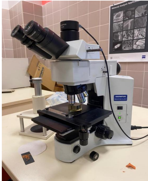
Şekil 4.9. Metalürjik inceleme için kullanılan optik mikroskop
