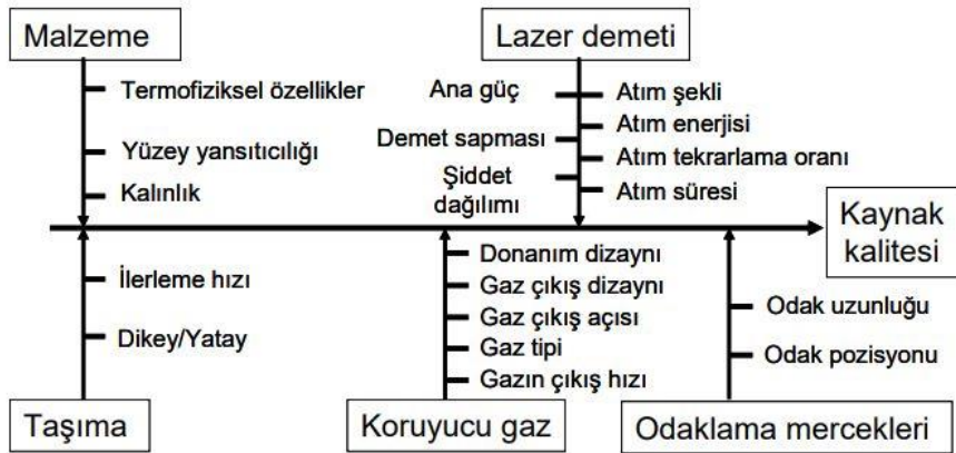
Şekil 3.19. Lazer kaynağında kaynağın kalitesine etkisi olan kaynak parametreleri (Akman, 2006)
