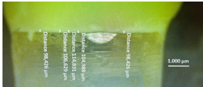
Şekil 3.14. Simantasyon işleminden sonra marjinal uyumun stereomikroskopta değerlendirilmesi
