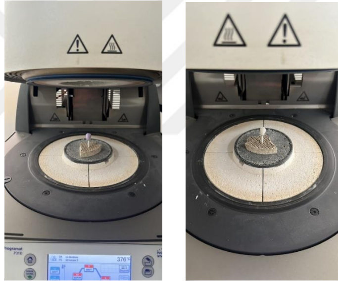
Şekil 3.6. Lityum disilikat kuronların sinterizasyon aşaması
