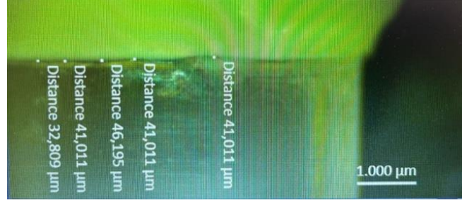
Şekil 3.12. Simantasyon işleminden önce marjinal uyumun stereomikroskopta değerlendirilmesi
