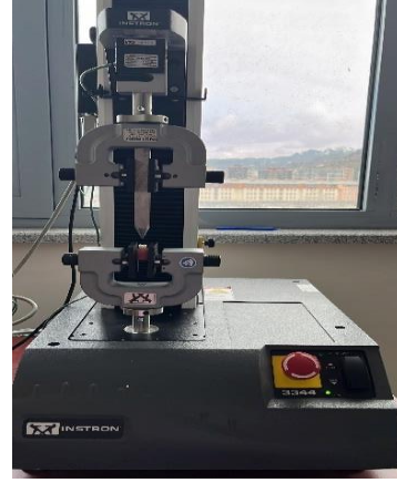
Şekil 3.18. Instron Universal test cihazında kuvvet uygulanması
