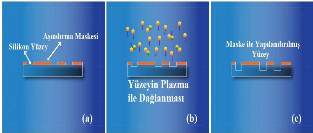
Şekil 3.33. Plazma ile yüzey aşındırma a) Plazma uygulanmadan önce aşındırma maskesi yerleştirilmiş malzeme yüzeyi, b) Plazma uygulandığındaki malzeme yüzeyi, c) Plazma uygulaması sonrasındaki malzeme yüzeyi (Henniker Plasma, 2022).
