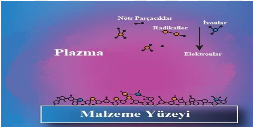
Şekil 3.34. Plazma ile malzeme yüzeyinde çapraz bağların oluşturulması (Henniker Plasma, 2022).
