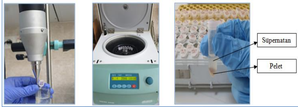
Resim 3.8. Homojenizasyon, Santrifüj ve Süpernatant alınması işlemleri
