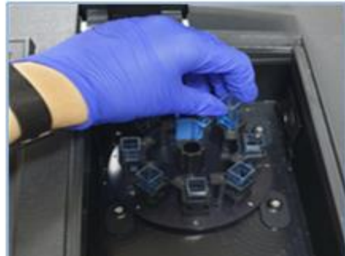
Resim 3.10. AOPP parametresinin uygulanması ve spektrofotometre cihazında okuma
