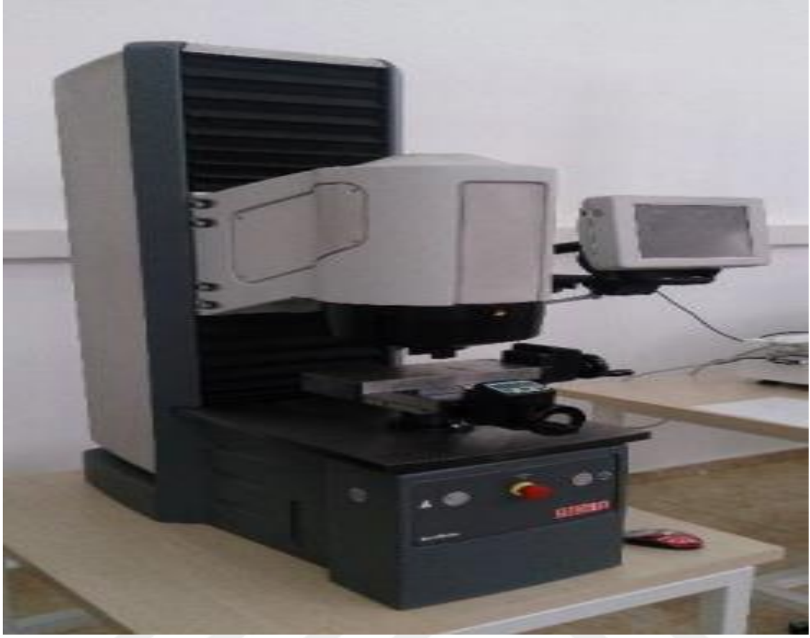
Resim 3.10. Emco Test Duravision 2000 model sertlik cihazı
