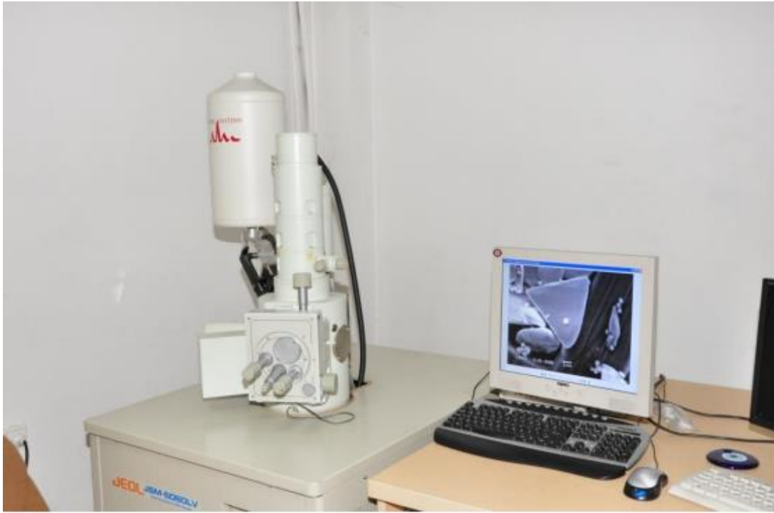
Resim 3.8. Jeol JEM 6060 LV tarama elektron mikroskobu (EDS ünitesi mevcut)
