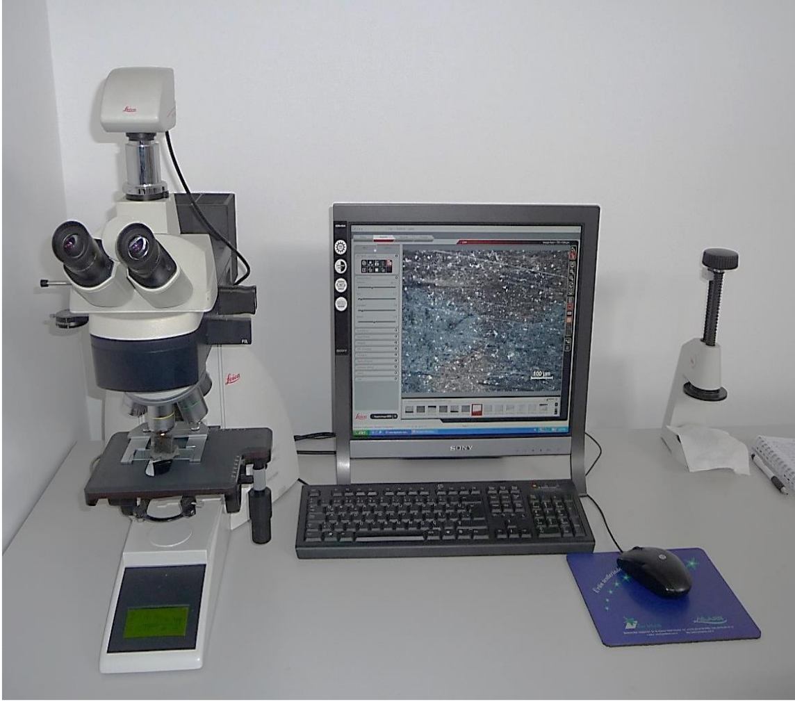
Resim 3.9. Leika DM 4000M metal mikroskobu
