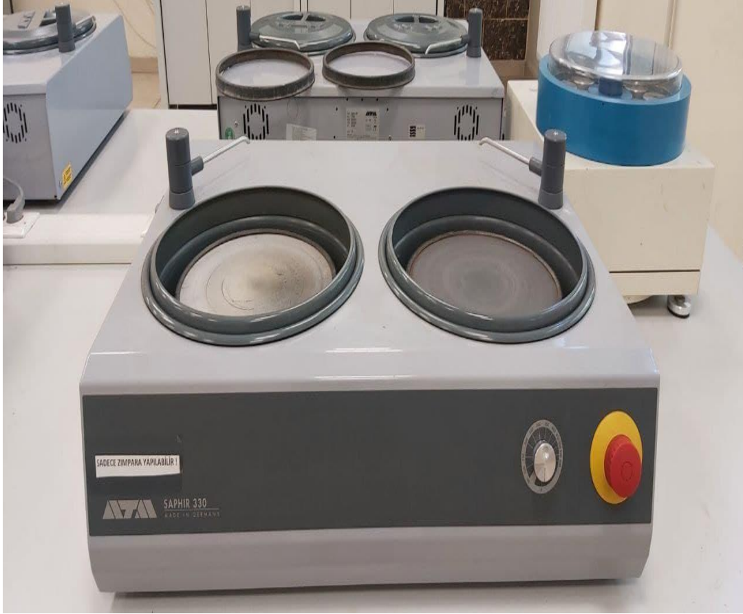
Resim 3.5. ATM Saphir 330 manyetik çift diskli zımpara-parlatma cihazı
