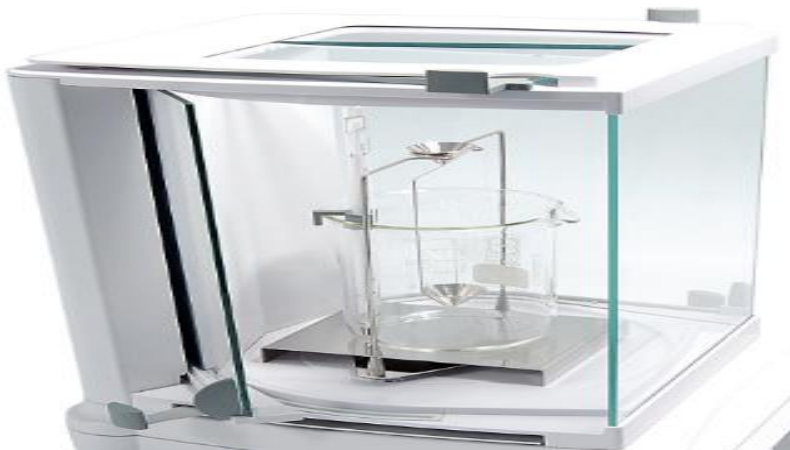
Resim 3.7. Sartorius marka yoğunluk ölçme cihazı
