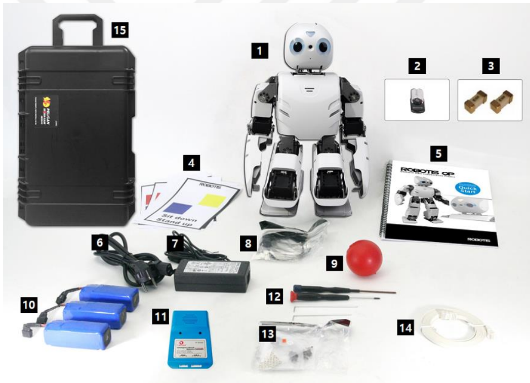
Şekil 2.4. Robotis-OP2 insansı robot platformunun içeriği
