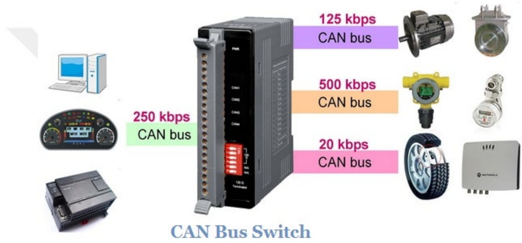
Şekil 6.10. Araç komponentlerinin birbiri ile haberleşmesini sağlayan CAN-Bus ağı.
