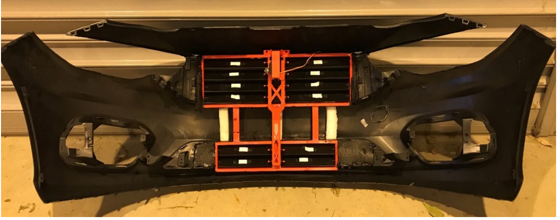
Şekil 5.11. Aktif ızgara sisteminin test aracı tamponuna montajlanması.
