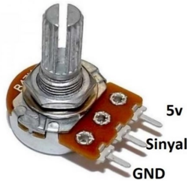
Şekil 6.4. Potansiyometre bağlantı şeması.
