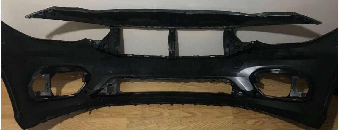
Şekil 5.10. Test aracı tamponunun montaj işlemi öncesinde hali.
