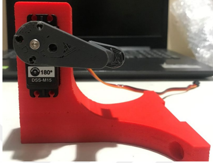
Şekil 5.9. Motor destek parçası ve motor bağlantısı.
