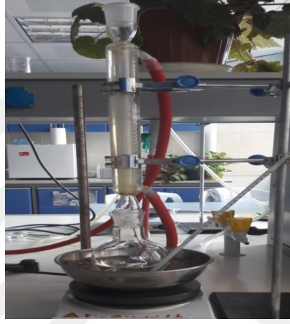
Şekil 2.2 : Silanlı imin bileşiğinin geri soğutucu altında sentezi.
