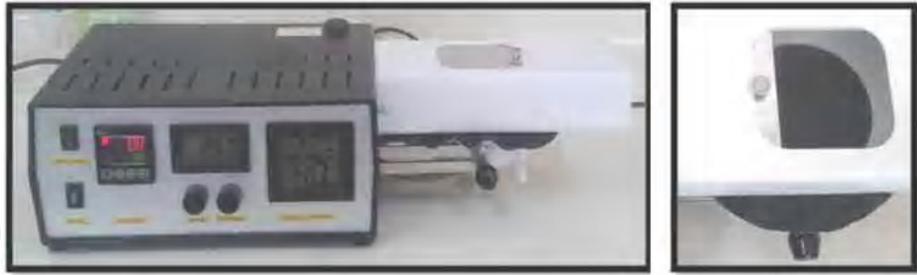
Şekil 2.12. Permetest su buharı direnci test cihazı.
