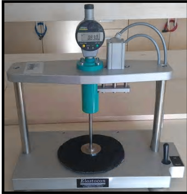
Şekil 2.2. Elastocon EV 07B dijital kalınlık cihazı.
