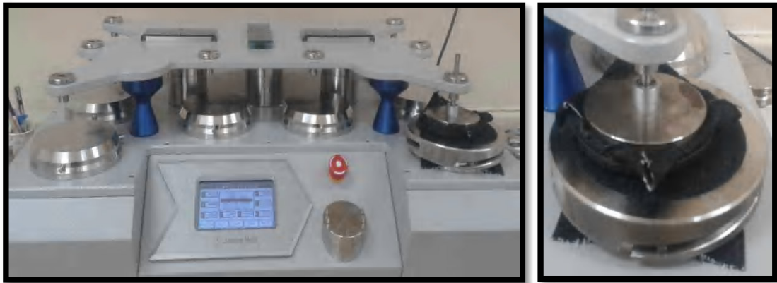
Şekil 2.4. Martindale aşınma ve pilling test cihazı.
