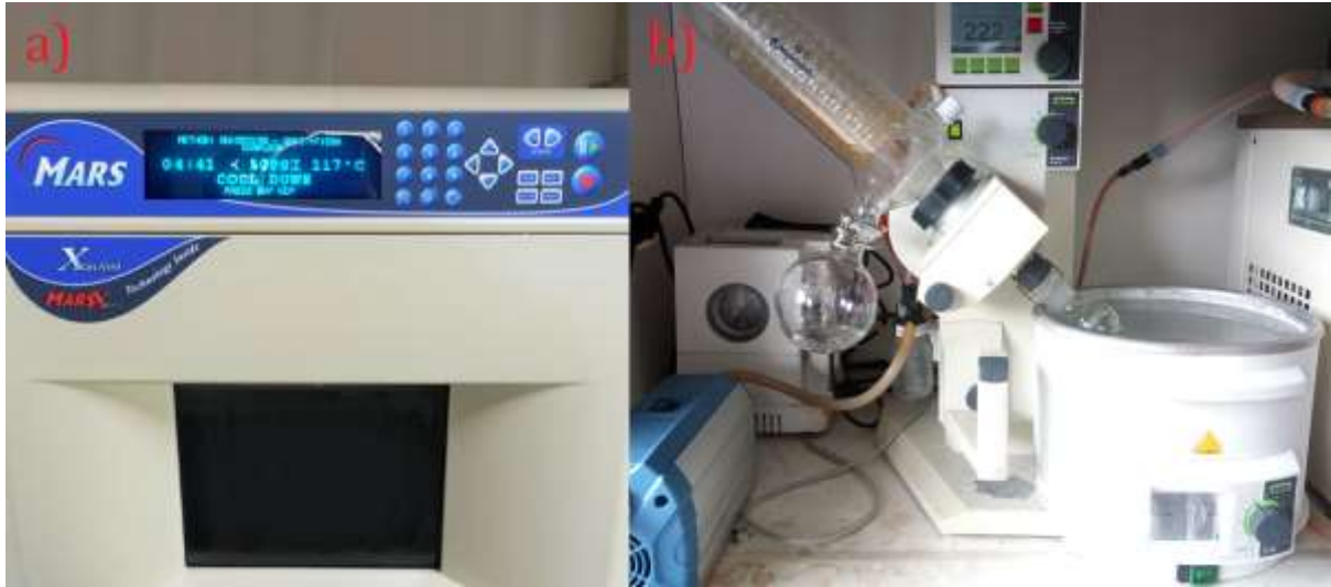
Şekil 3.5. (a) Mikrodalga ekstraksiyonunun deney sistemi, (b) Mikrodalga ekstraksiyonu sisteminde kullanılan döner buharlaştırıcı sistemi.
