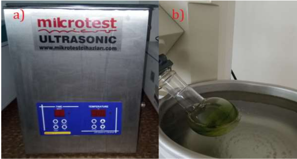
Şekil 3.4. (a) Ultrasonik ekstraksiyonunun deney sistemi, (b) döner buharlaştırıcı sistemi.
