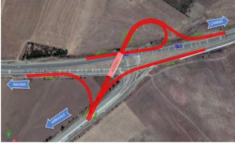
Şekil 4.15. Kavşak bölgesi uydu görüntüsü-2 (Kavşak bölgesi için önerilen trompet tipi farklı seviyeli kavşak yerleşimi)
