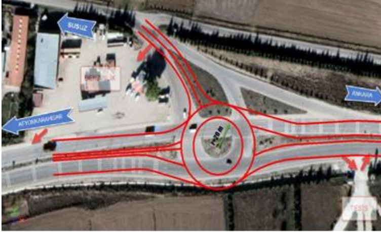
Şekil 4.5. Kavşak bölgesi uydu görüntüsü-3 (Kavşak bölgesinde modern dönel kavşak yerleşimi önerisi)
