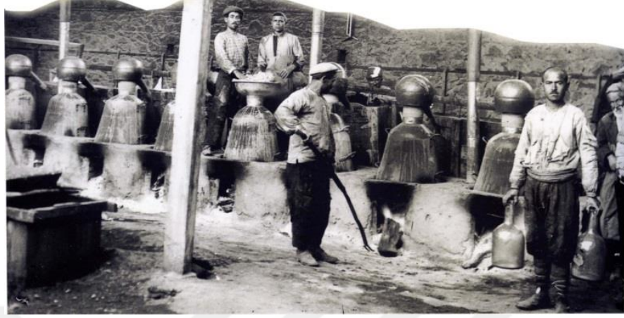
Resim 1. 1930 Gül Yağı Fabrikasında İmbikten Gülyağı Çıkarma İşlemi (Resim: Isparta 1880-1980, Isparta Valiliği)
