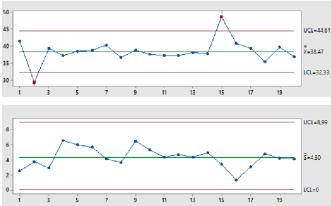
Şekil 6. 22. Kesin veriler için \bar{X} -s kontrol grafiği
