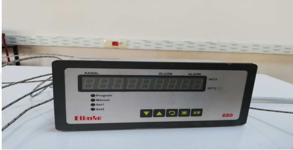
Şekil 5.4: Deney setinde kullanılan dijital sıcaklık göstergesi
