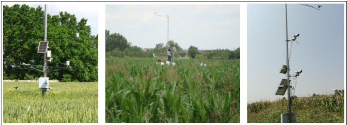
Şekil 2.3. Portatif iklim istasyonu ile ölçüm yapılan Bowen Enerji Oranı Yöntemi Anonim (2016a)
