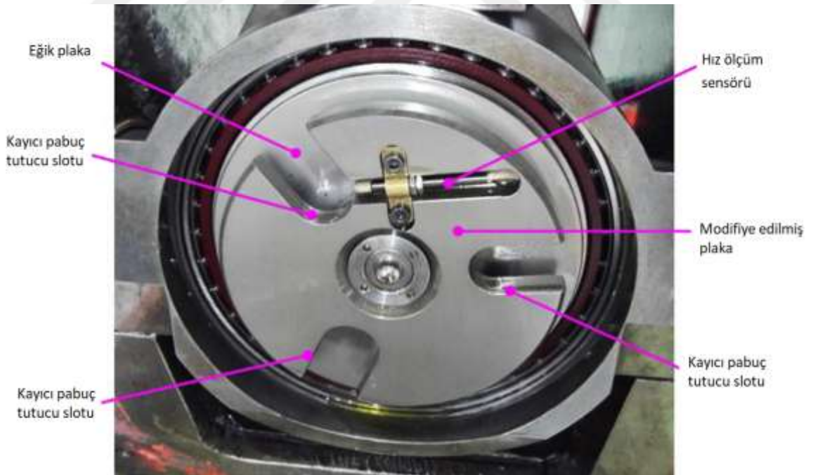
Şekil 1.7. Kayıcı pabuç dönme hızı ölçüm deney seti [32]
