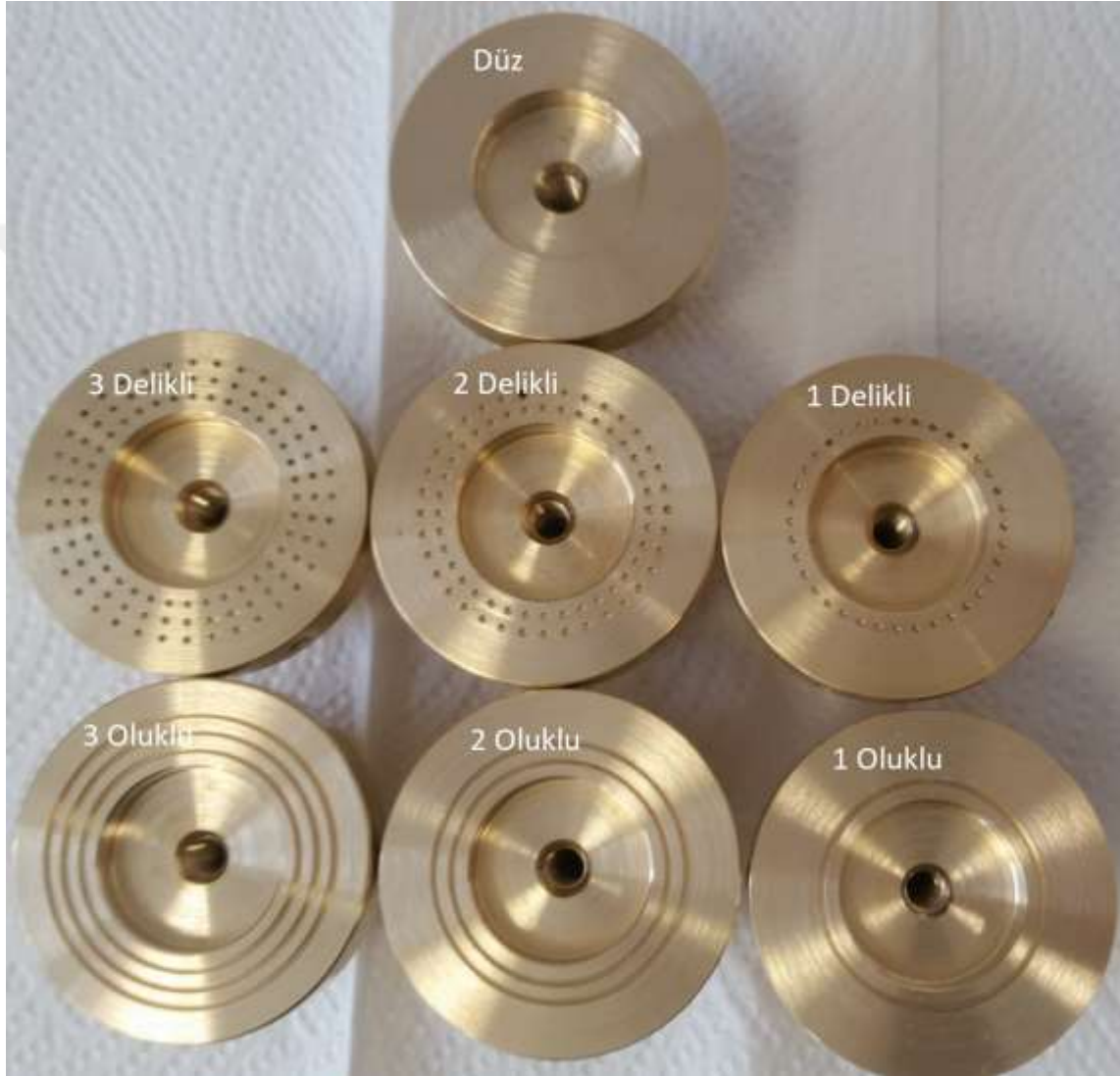
Şekil 2.11. Deneylerde kullanılan oluklu ve dairesel delikli kayıcı pabuçlar
