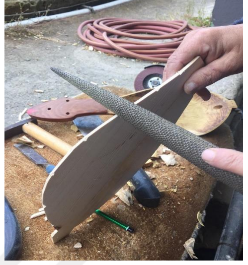
Ses tahtasının hazırlanma ve formunun verililiş aşaması
