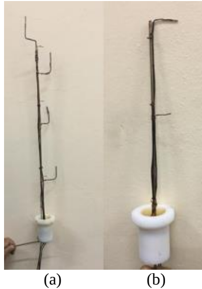
Şekil 2.14. (a) Kurutma odası içerisindeki, (b) Ürün odası içerisindeki sıcaklıkların ölçüm düzeneği
