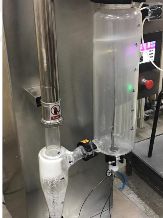
Şekil 3.6. Geliştirilmiş püskürtmeli kurutucudaki kurutma ve ürün odası duvarları
