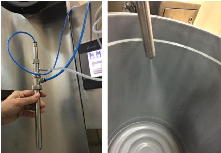
Şekil 2.4. İki akışlı basınçlı sprej nozul atomizer
