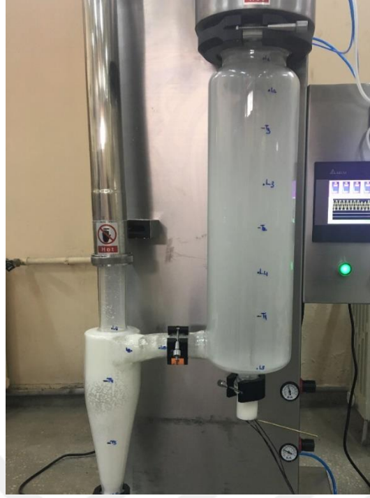
Şekil 3.5. Standart püskürtmeli kurutucudaki kurutma ve ürün odası duvarları
