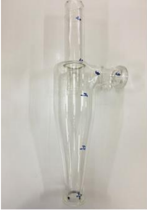
Şekil 2.16. Ürün odası içerisindeki hava ve cam sıcaklıklarının ölçüm noktaları
