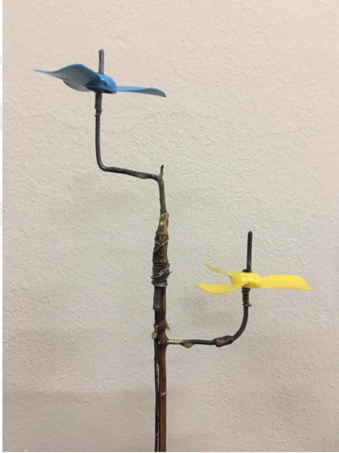
Şekil 2.6. Geliştirilmiş püskürtmeli kurutucuda kurutma odasına yerleştirilen pervaneler
